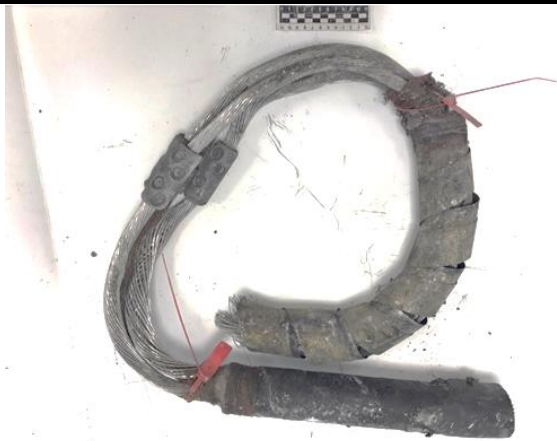
Участок бронированного алюминиевого кабеля с изоляцией
