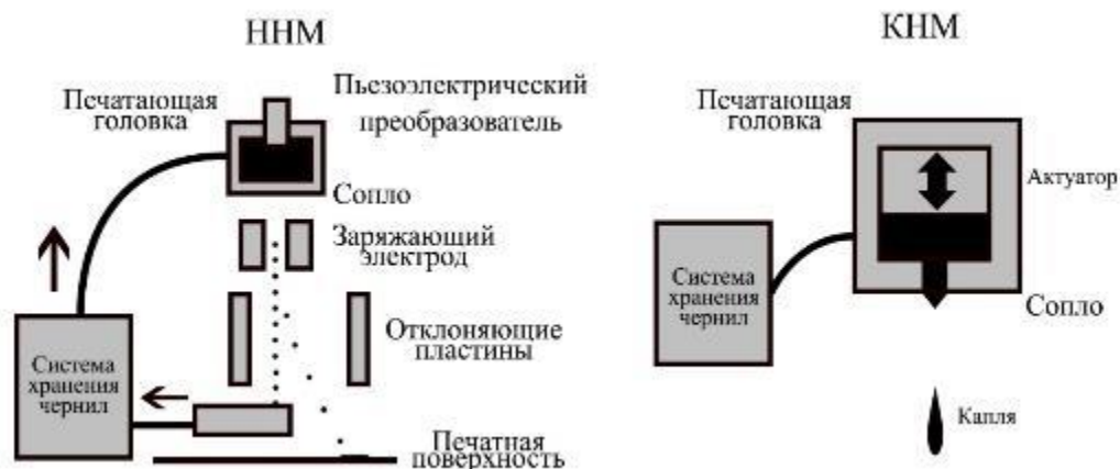
Рисунок 7 - Принцип работы метода струйной печати [16]
