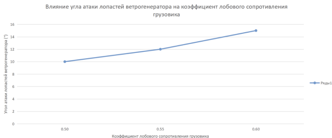
Рисунок 2. - Влияние угла атаки лопастей ветрогенератора на коэффициент лобового сопротивления грузовика
