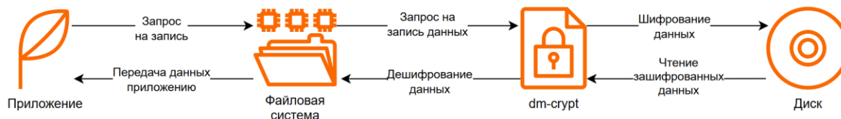
Рисунок 1 – Алгоритм работы dm-crypt
