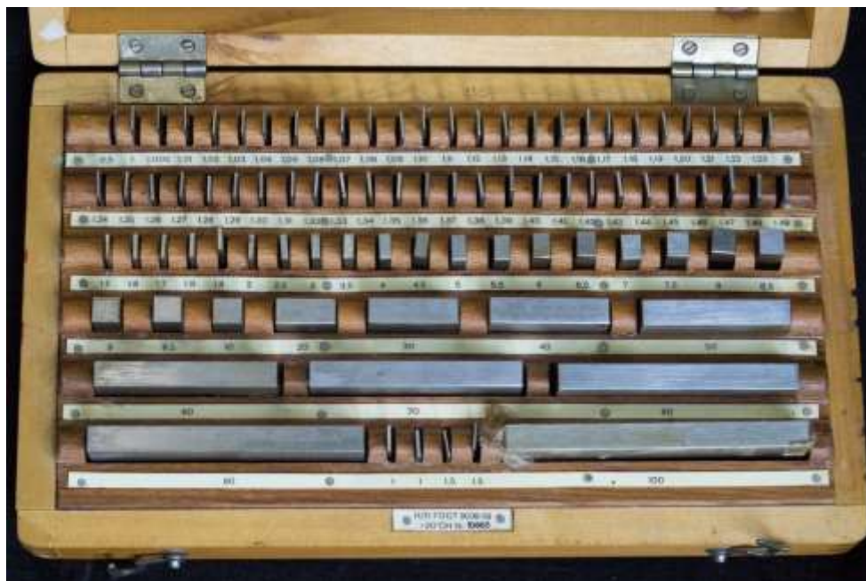
Рисунок 1 – Концевые меры длины Иогансона
