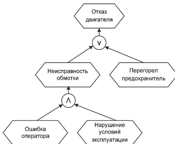
Рисунок 3 – Диаграмма структурного аспекта рисков для события «отказ двигателя»
