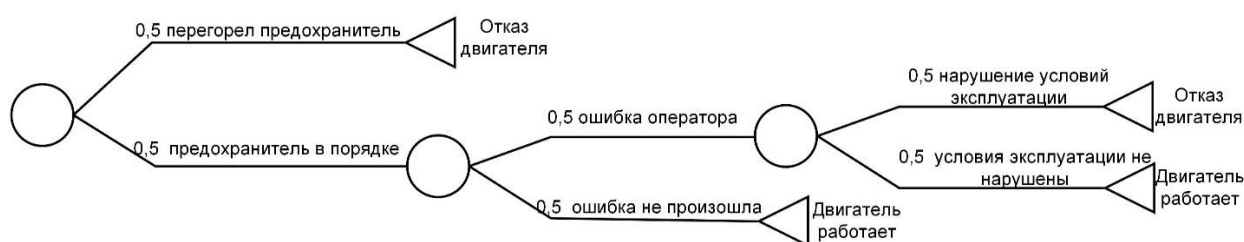
Рисунок 4 – Модель дерева решений для события «отказ двигателя»
