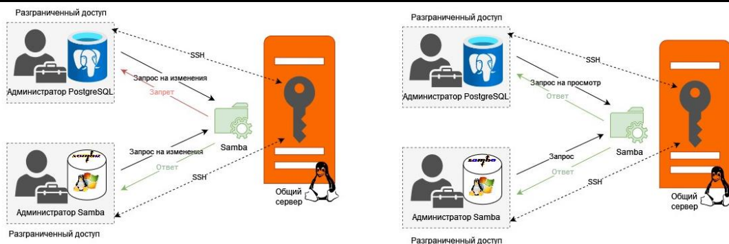
Рисунок 10 – Алгоритм взаимодействия после устранения возможности возникновения конфликта
