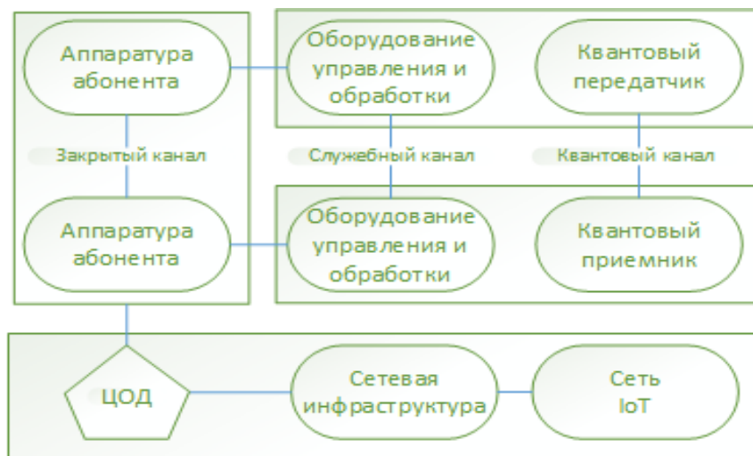
Рис. 2. Схема интеграции квантовых коммуникаций в инфраструктуру управления сетью интернета вещей
