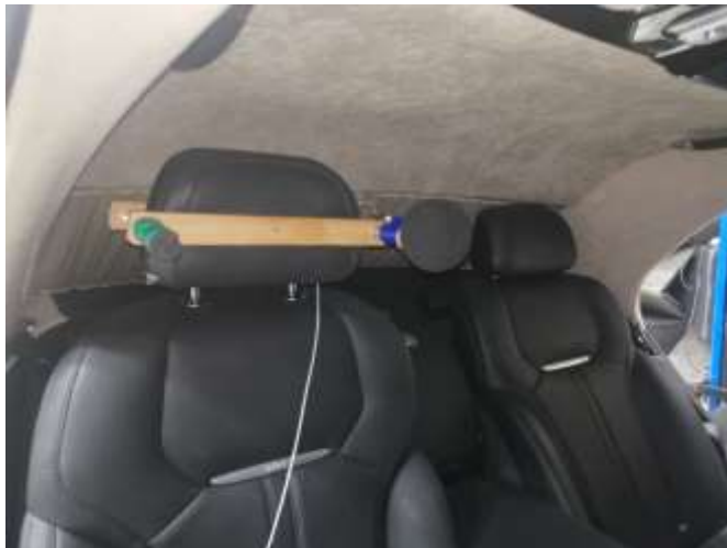
Рисунок 14. - Точка отклика при исследовании ФПШ.
