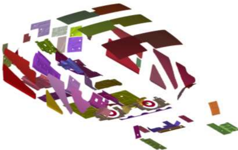
Рисунок 4. - Вибродемпфирующие материалы установленные на зеленом кузове.
