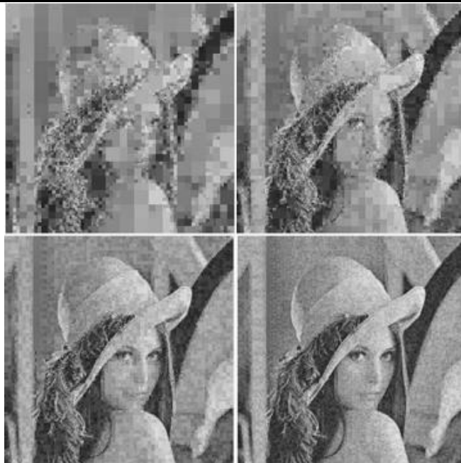
Рисунок 4 – Процесс восстановления изображения, сжатого при помощи способа фрактального алгоритма сжатия с измененной схемой покрытия ранговых блоков доменными
