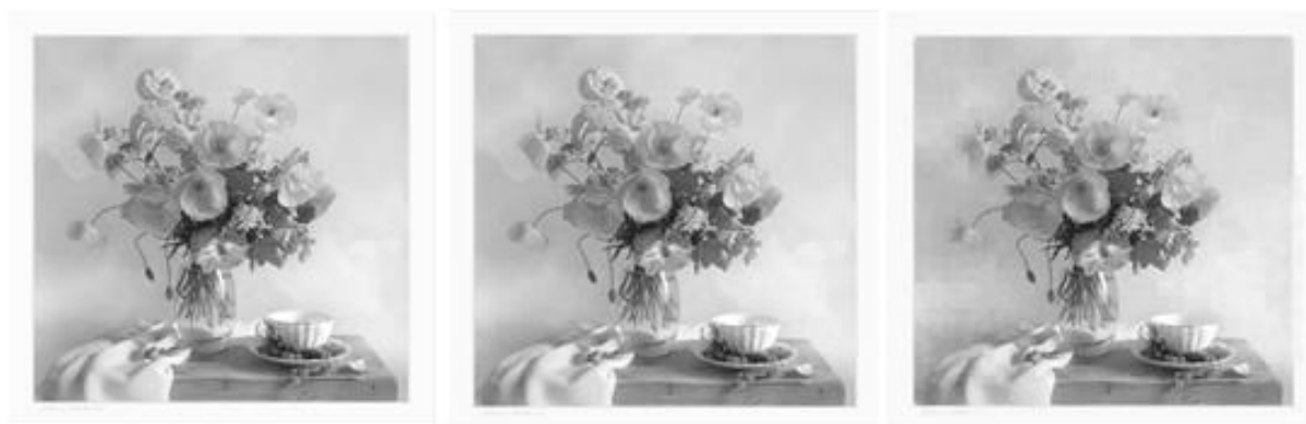
Рисунок 5 – Оригинальное изображение (а); изображение, сжатое и восстановленное классическим способом фрактального сжатия (б); изображение, сжатое и восстановленное способом фрактального сжатия с использованием дерева квадрантов (в)
