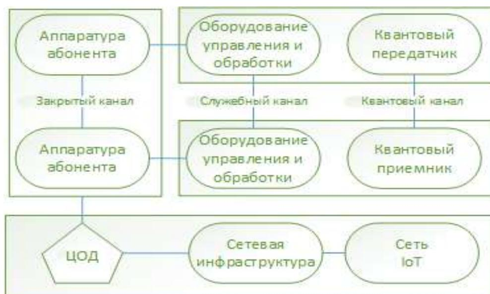
Рисунок 2 – Схема интеграции квантовых коммуникаций в инфраструктуру управления сетью интернета вещей
