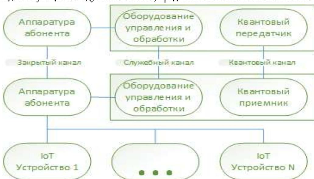
Рисунок 1 – Схема интеграции квантовых коммуникаций в инфраструктуру управления сетью интернета вещей
