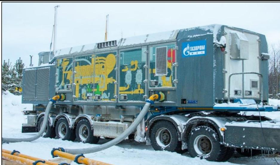
Рисунок 6 – Мобильная компрессорная станция
