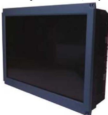
Рисунок 8 – Многофункциональный индикатор ИМ- 21-2
