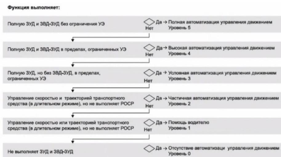
Рисунок 1 – Упрощенная логическая схема для выбора уровня автоматизации управления движением БПА
