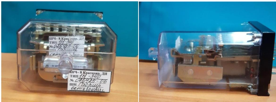
Рисунок 1 – Электромагнитное реле типа 1Н-1350
