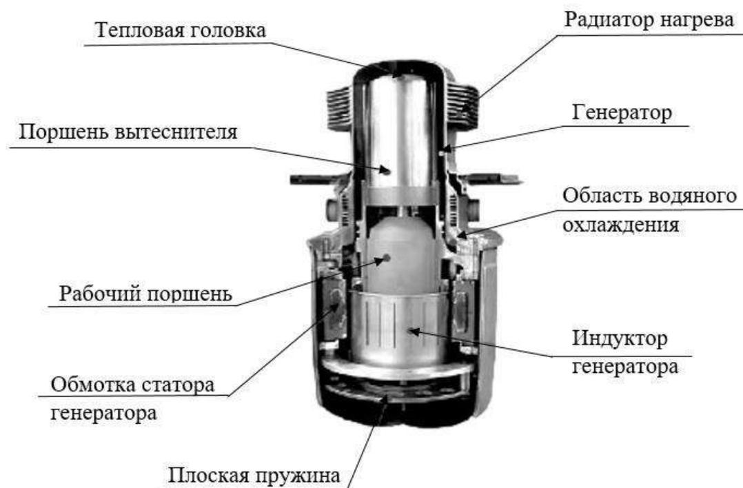
Рисунок 2 – Устройство двигателя Стирлинга
