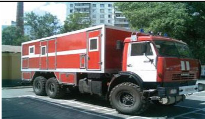
Рисунок 4 – Установка ТАВ на автомобильном шасси КАМАЗ
