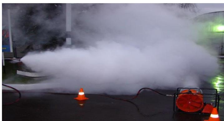
Рисунок 3 – Тушение пожара поверхностным способом с помощью ТАВ
