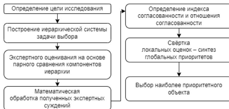
Рисунок 1 – Общий принцип применения МАИ
