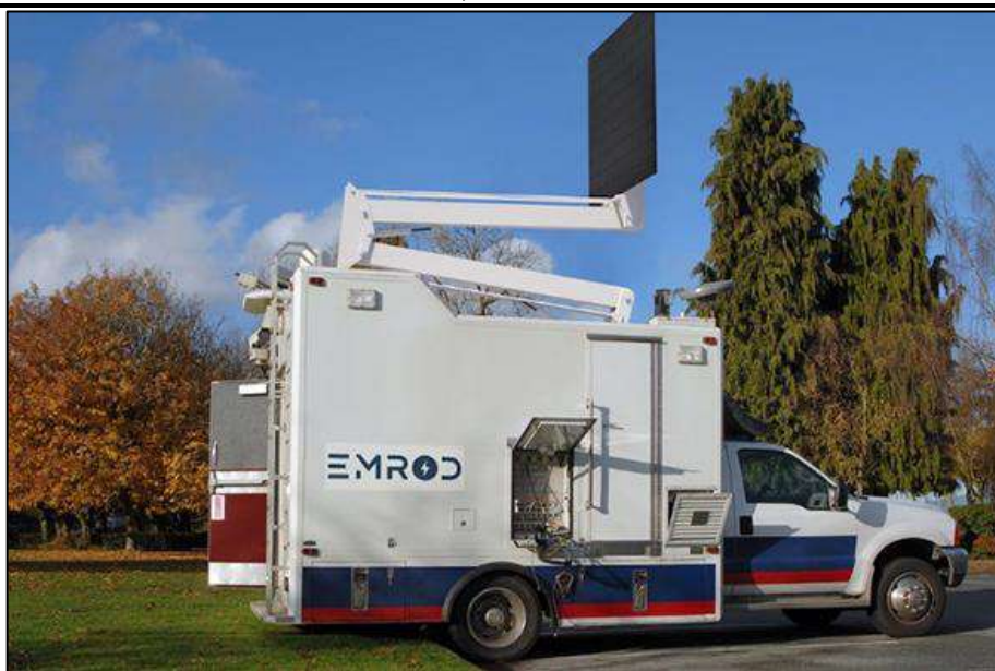
Рисунок 8 – Приёмник микроволновых волн Emord [7, с. 3-4]
