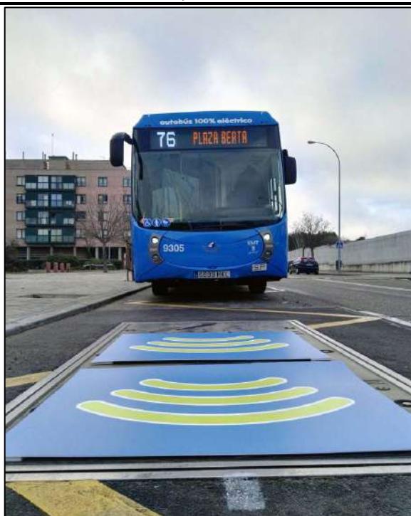
Рисунок 7 – Зарядная площадка электробуса [3, с. 1-2]
