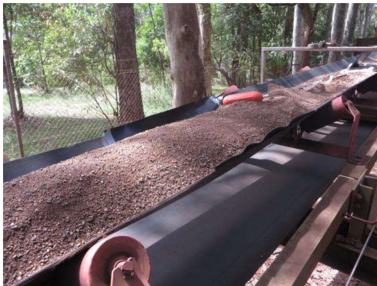
Рисунок 1 – Конвейерная лента, загруженная речным песком
