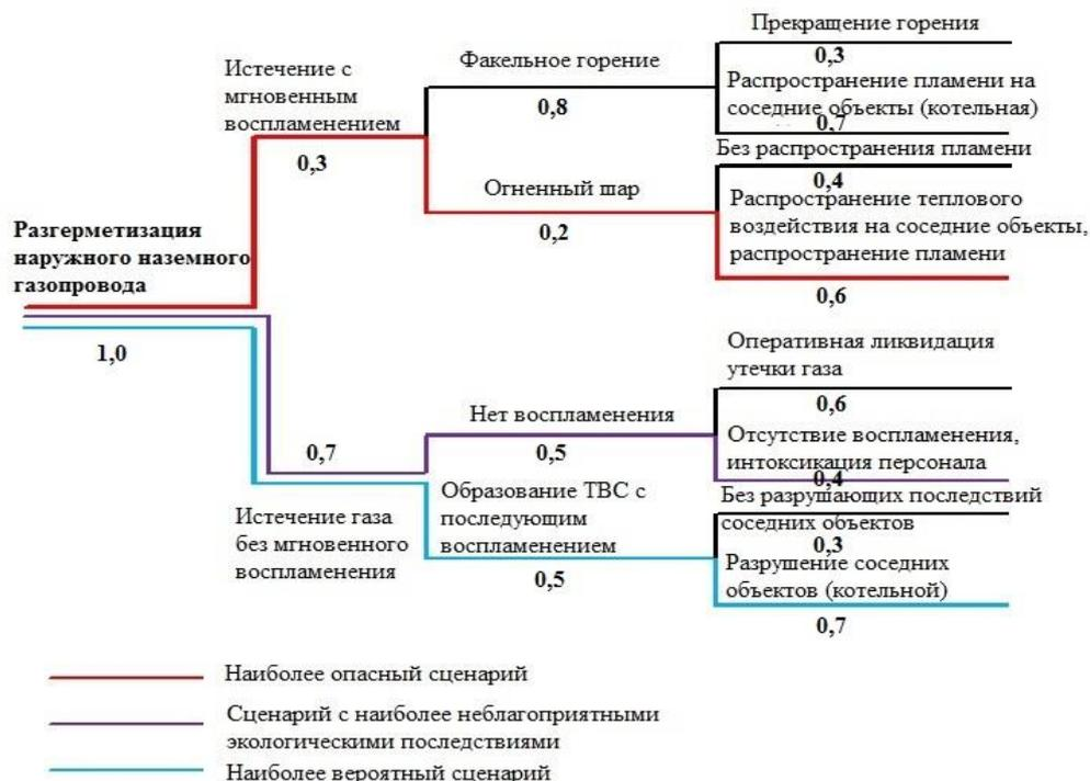
Рисунок 1 – Дерево событий аварийного разрушения газопровода котельной машиностроительного предприятия
