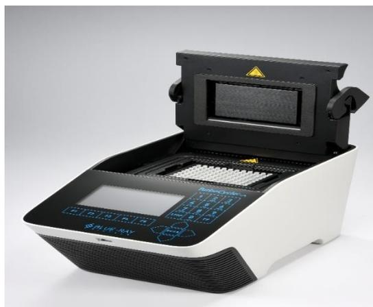
Рисунок 6 – Амплификатор (термоциклер, ПЦР-машина)
