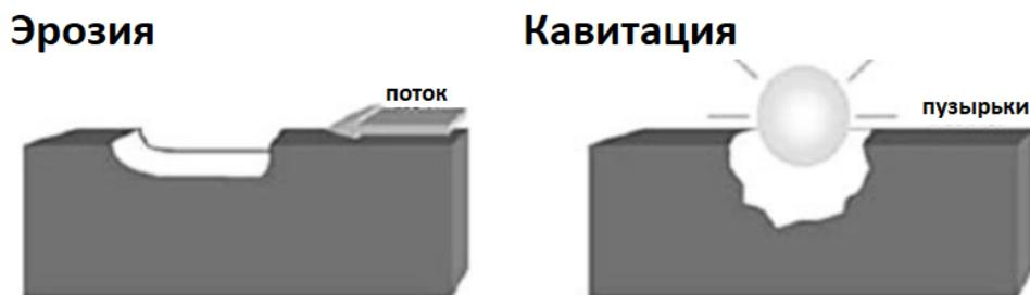
Рисунок 2 – Сравнение типичной кавитационной ямы и эрозии
