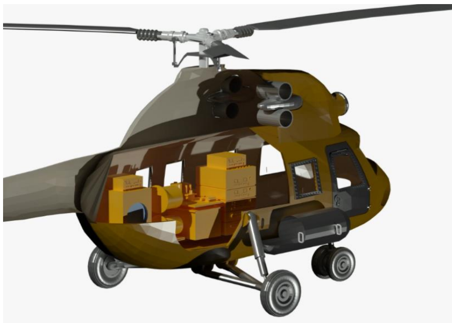
Рисунок 2 – Размещение оборудования в грузовом отсеке вертолета МИ-2
