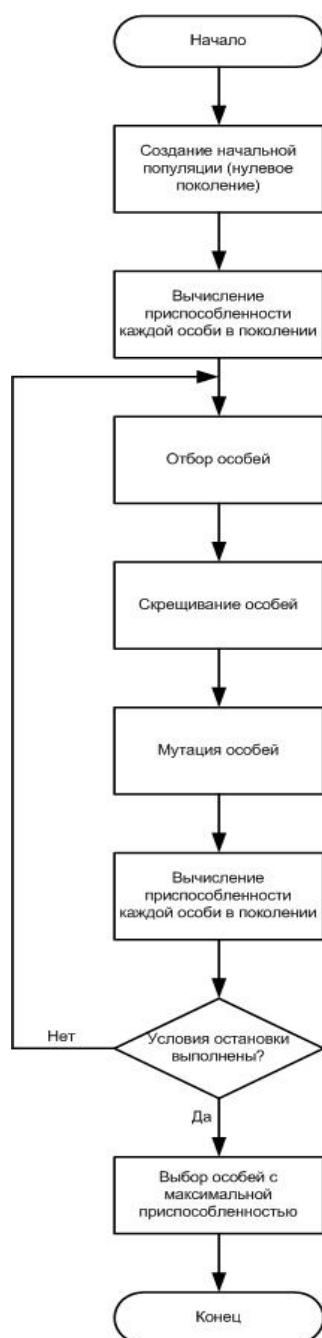
Рисунок 2 - Общая схема работы генетического алгоритма
