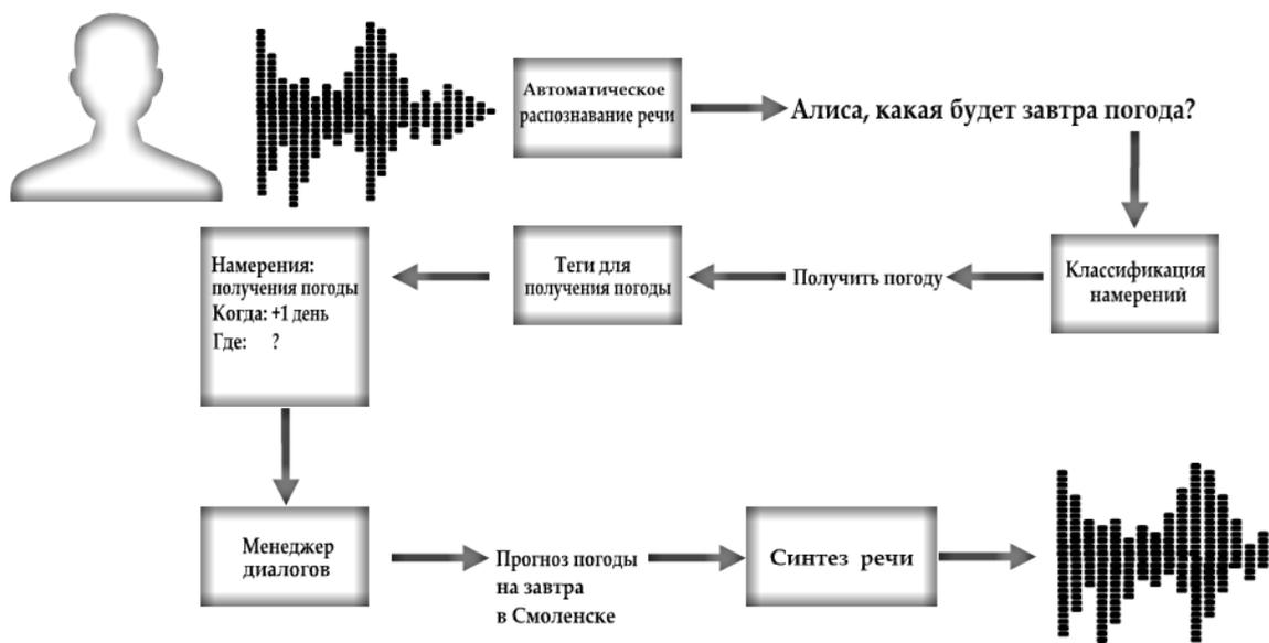
Рисунок 2 – Обработка звукового запроса виртуальным ассистентом
