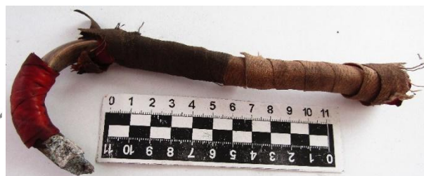
Фрагмент алюминиевого секторного кабеля
