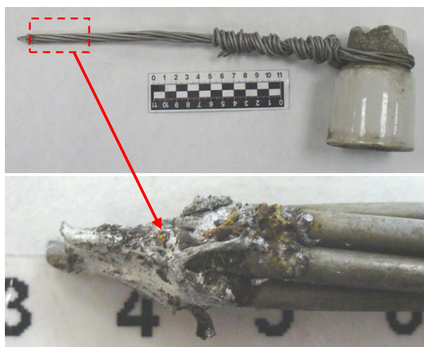
Изолятор с присоединенным к нему алюминиевым проводником, оплавленным на конце.
