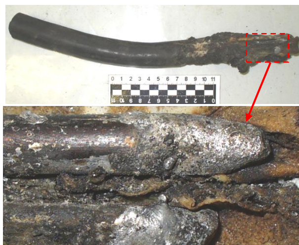
Фрагмент силового алюминиевого кабеля и крупный план его участка
