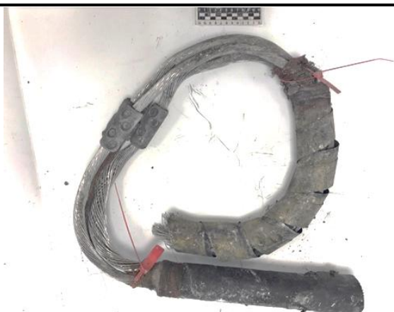
Участок бронированного алюминиевого кабеля с изоляцией
