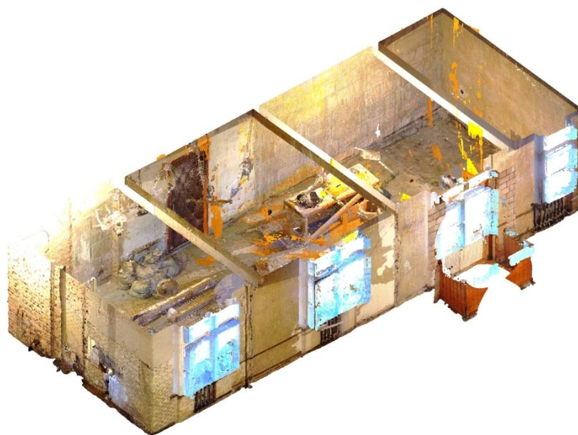
Рисунок 2 - Облако точек по результатам лазерного сканирования
