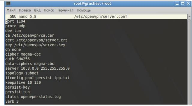
Рисунок 7 - Конфигурация сервера.
