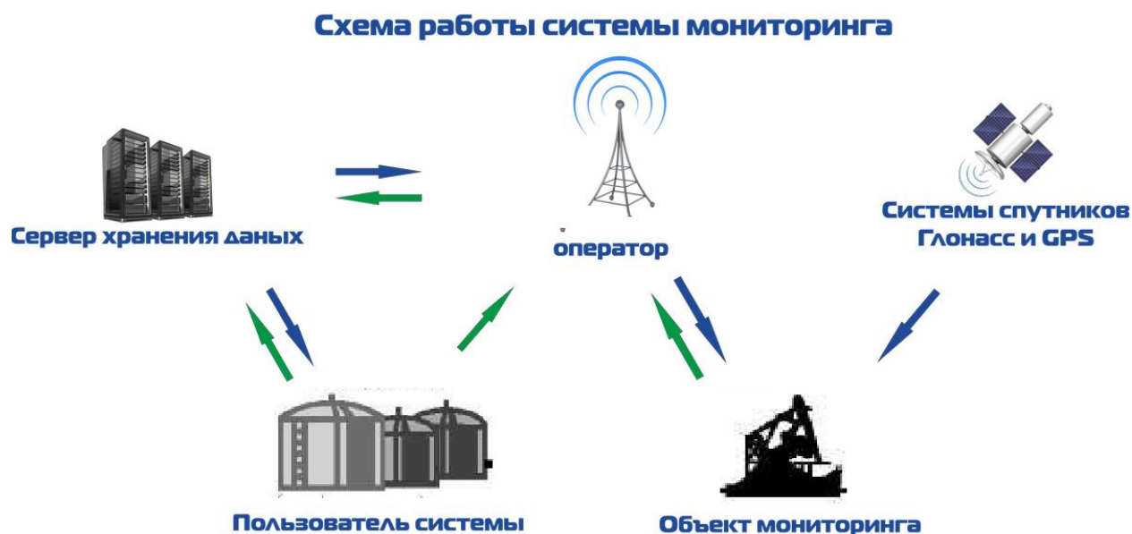
Рисунок 3 - Мониторинг магистрали трубопровода с помощью системы ГЛОНАСС/ GPS
