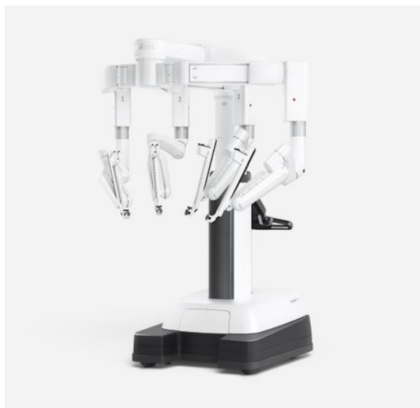
Рисунок 1. - Хирургическая система da Vinci Источник: изображение с сайта компании Intuitive
