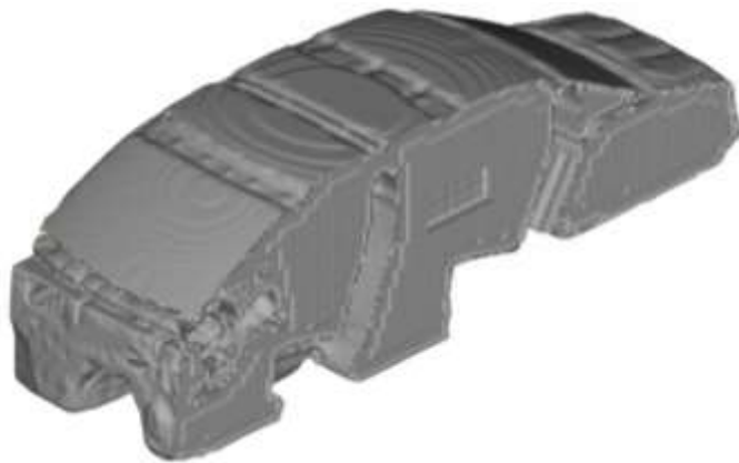
Рисунок 1. - КЭМ зеленого кузова для исследований ФПШ: а-структурная и б – внутренний акустический воздушного объема
