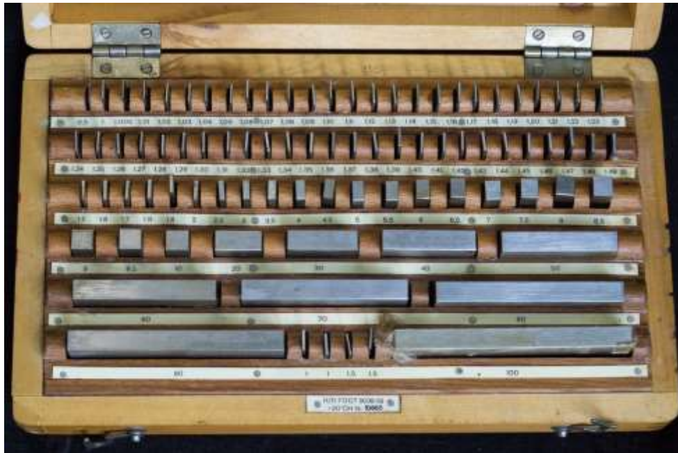
Рисунок 1 – Концевые меры длины Иогансона
