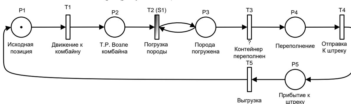
Рисунок 2 – Элементная сеть транспортного робота
