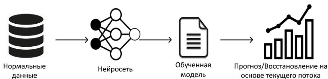
Рисунок 1 – Обнаружение сбоев при использовании нейросети
