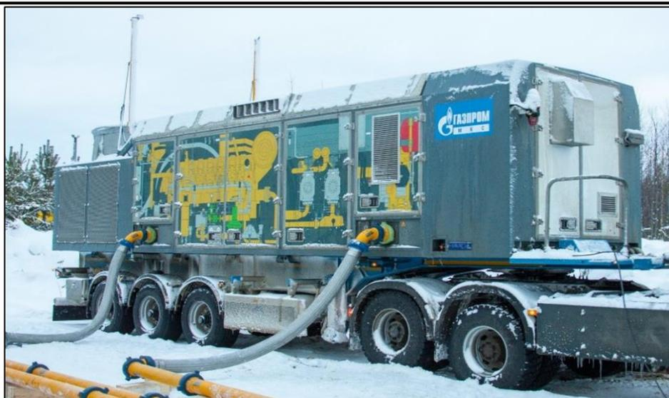
Рисунок 6 – Мобильная компрессорная станция
