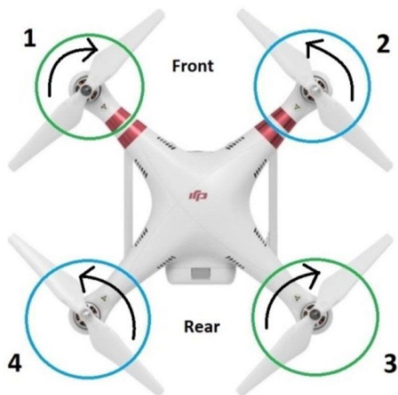
Рисунок 3 – Схема вращения двигателей Квадрокоптера
