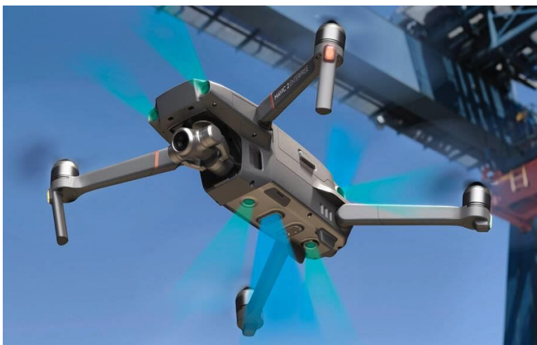
Рисунок 6 – Работы VPS на квадрокоптере DJI Mavic 2 Zoom
