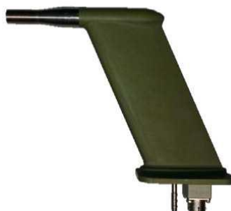
Рисунок 14 – Приемник полного давления ППД-21
