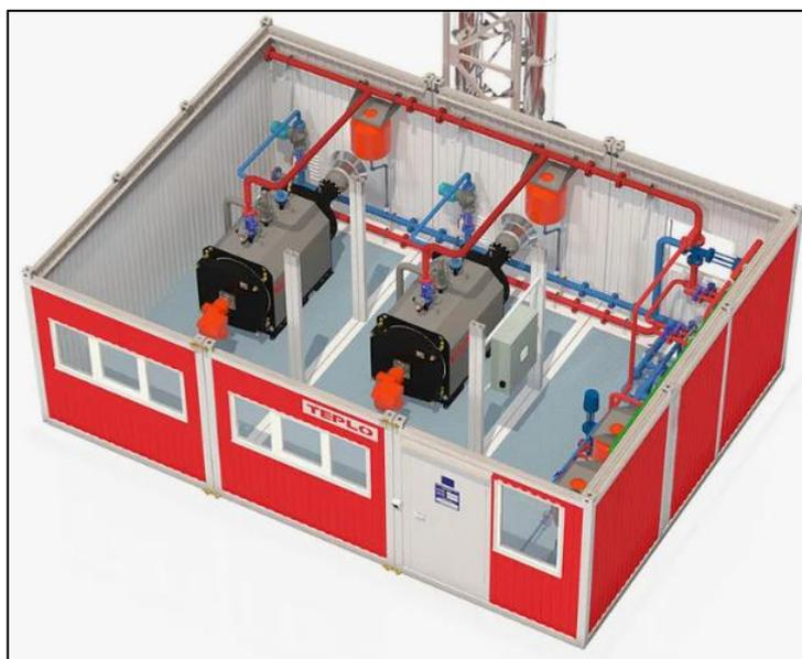
Рисунок 1 – 3D модель блочно – модульной котельной
