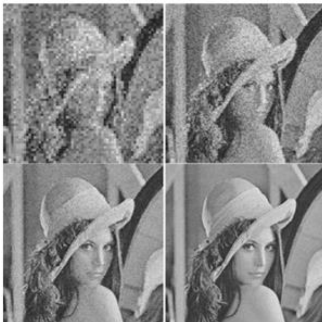
Рисунок 3 – Процесс восстановления изображения, сжатого при помощи классического способа фрактального алгоритма сжатия
