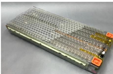
Рисунок 3 – Модуль аккумуляторной батареи для беспилотного грузового автомобиля Tesla
