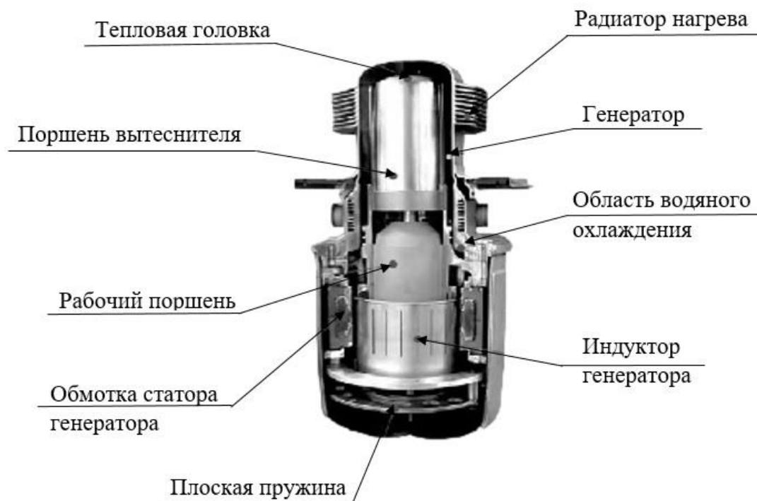
Рисунок 2 – Устройство двигателя Стирлинга
