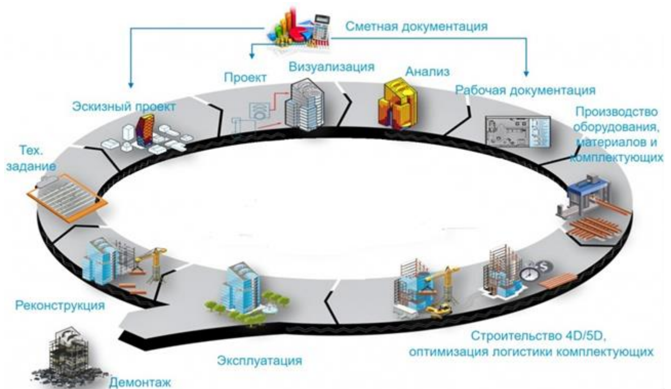
Рисунок 1.2 – Жизненный цикл объекта строительства
