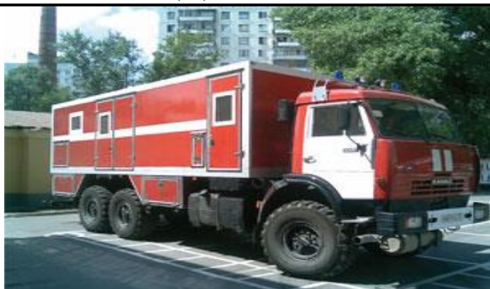
Рисунок 4 – Установка ТАВ на автомобильном шасси КАМАЗ
