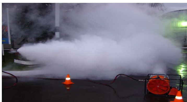
Рисунок 3 – Тушение пожара поверхностным способом с помощью ТАВ
