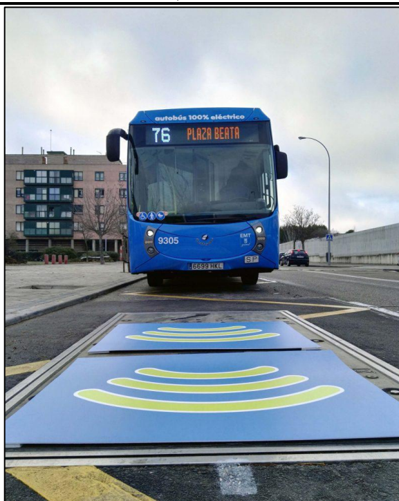
Рисунок 7 – Зарядная площадка электробуса [3, с. 1-2]
