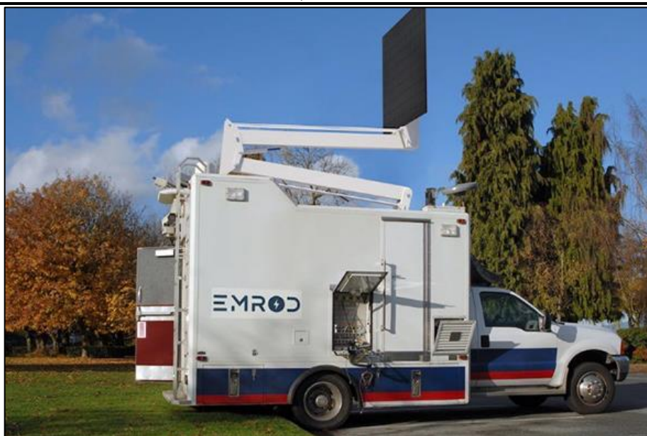
Рисунок 8 – Приёмник микроволновых волн Emord [7, с. 3-4]
