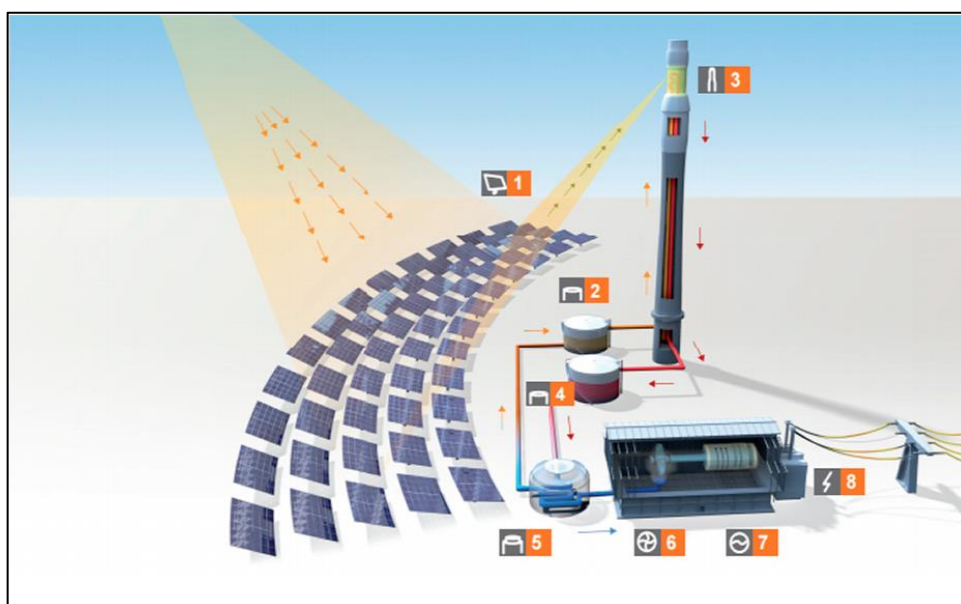
Рисунок 7 – Схема электростанции, работающей на расплавленной соли
