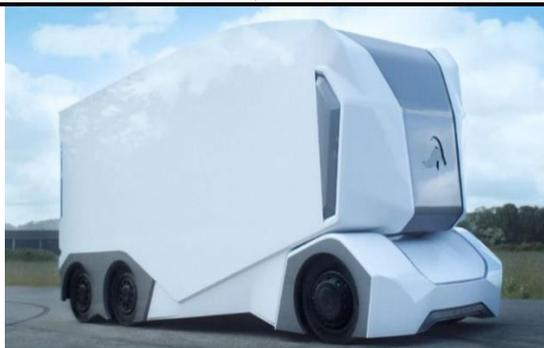
Рисунок 4 – Беспилотный тягач T-rod.
