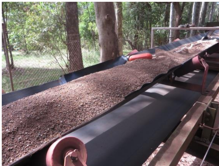
Рисунок 1 – Конвейерная лента, загруженная речным песком
