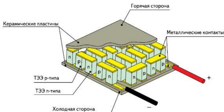
Рисунок 4 – Элемент Пельтье в разрезе
