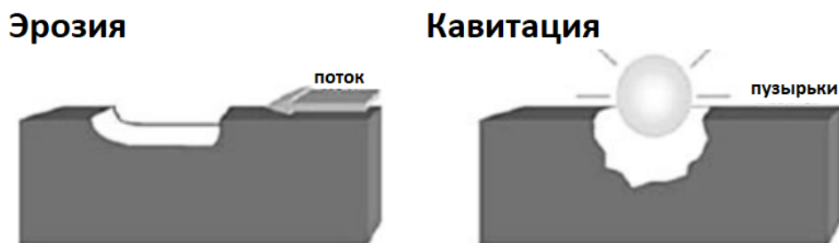
Рисунок 2 – Сравнение типичной кавитационной ямы и эрозии
