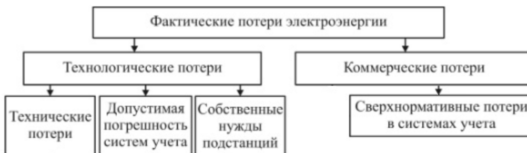
Рисунок 1 – Структура потерь электроэнергии в электрических сетях
